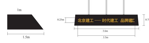
现场需设有"五板两图",材质应为不锈钢橱窗。五板:施工现场安全制度、施工现场消防保卫制度、施工现场场容管理制度、 环保基本内容和施工现场卫生基本要求。两图:施工现场平面布置图和施工现场责任区划分图。单块图板尺寸为2.1米高,2米长,其 中图板底边距地面1.1米,图板上部要有"集团标识+北京建工X建公司"蓝字,图板上文字颜色为建工蓝,字体为黑体。
