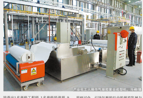
产业化工人操作气凝胶成型压机。马峰/摄
