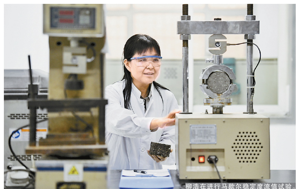
柳浩在进行马歇尔稳定度流值试验。
